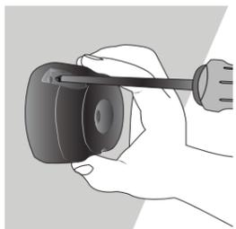
A l'aide d'un tournevis cruciforme, vissez le socle avec les vis fournies. Vérifiez que la base est solidement fixée.
