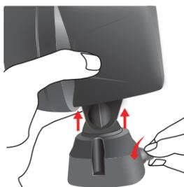
Retirez la base en tournant la molette du socle de montage dans le sens inverse des aiguilles d'une montre.
