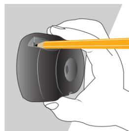
Choisissez l'emplacement de fixation. A l'aide d'un crayon, notez les zones de perçage à travers les trous du socle. Percez et insérez les chevilles dans les trous.
